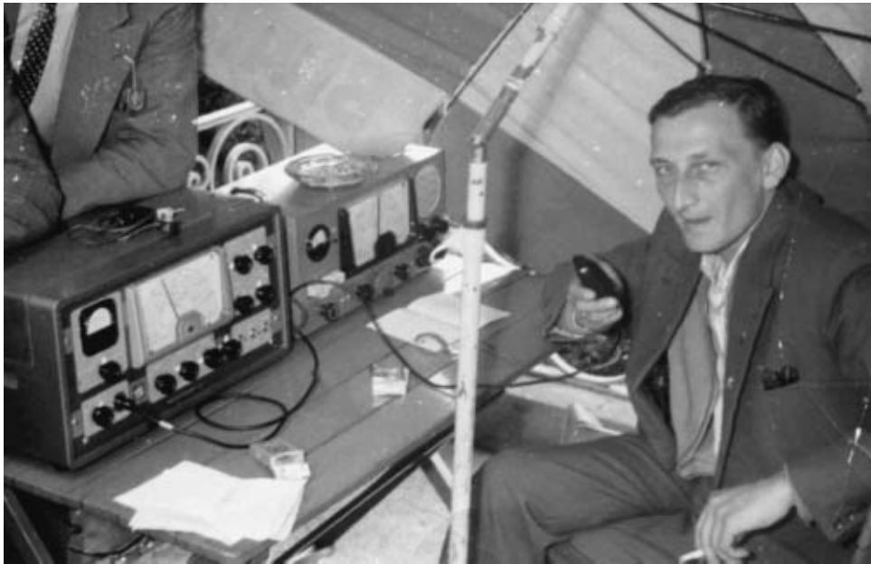
DJ2MK bei der Vorführung von Funkbetrieb beim Deutschlandtreffen 1957 in Coburg (Station: links ein Geloso-Empfänger, rechts daneben der von DJ2MK selbstgebaute Sender dazu)
